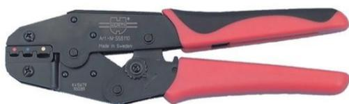
Crimpadora para cable aislado de 1.5-6.0mm
