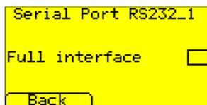
Ermöglicht Ihnen die Aktivierung von Normal (Grundeinstellung), Full, DTE- oder DCE-Schnittstellenmodus für den seriellen Port RS232\_1.
