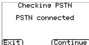
Der IRIS Touch Dialer prüft nun die PSTN-Verbindung daraufhin, ob die PSTN-Erweiterungskarte eingesetzt wurde und der PSTN-Netzwerk-Pfad ausgewählt wurde. Wird die Leitungsspannung erkannt, wird „angeschlossen“ angezeigt und Sie können fortfahren. Falls „PSTN getrennt“ angezeigt wird, prüfen Sie bitte die Kabel und Verbindung zur PSTN-Leitung. Das kann nach dem Einschalten bis zu 30 Sekunden
