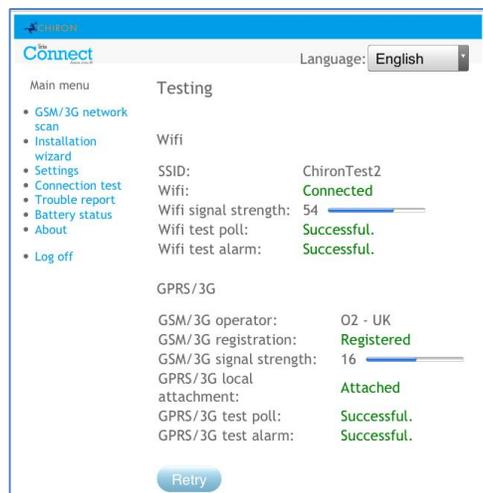
Le menu de test permet de vérifier toutes les voies actuelles de communication activées, et de tester à la fois les alarmes et la transmission.
