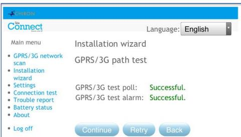
L'IRIS ToucConnect effectuera un test d'alarme et de transmission sur le réseau GPRS / 3G.
