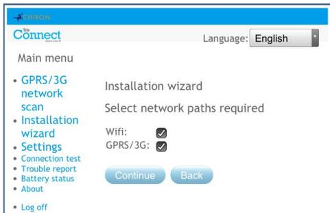
Le composeur IRIS Connect Uno peut communiquer via un chemin Wi-Fi unique, alors que l'IRIS Connect Duo dispose des options Wi-Fi et GPRS / 3G options pour les communications simples ou doubles.
