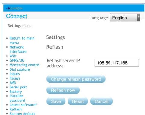
Quelques fois, un client n'ouvrira son réseau que pour communiquer avec le centre de surveillance (réseau / adresse IP), et, dans certains cas, le centre de surveillance disposera de son propre serveur de reflash. Cette option permet l'envoi d'une demande de reflashr à une autre adresse IP.
