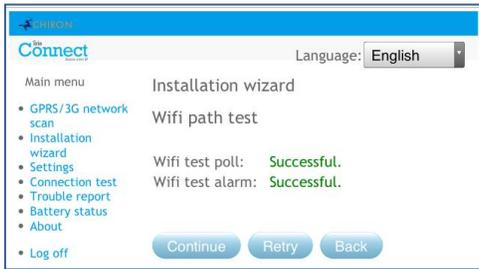
Ensuite, le composeur enverra un message d'alarme et un essai de transmission au centre de surveillance pour vérifier la connexion Wi-Fi. Assurez-vous que les deux soient réussis. Dans le cas contraire, le composeur indiquera les problèmes possibles et la configuration à vérifier comme indiqué ci-dessous :
