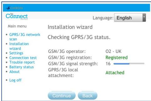
Si vous avez sélectionné une connexion via GPRS / 3G, le composeur affichera l'intensité actuelle du signal / opérateur pour le poste principal auquel il est actuellement rattaché.
