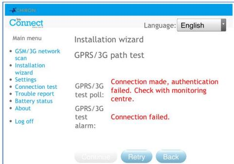
Cela indique que l'appel de transmission d'essai a atteint le système IRIS Secure Apps, mais que les clés de sécurité ne correspondent pas.
