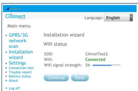
Le composeur va maintenant confirmer le nom du réseau Wi-Fi auquel il est connecté et l'intensité du signal.
