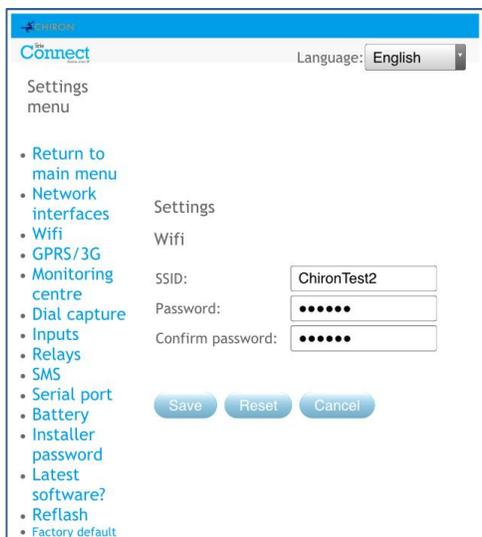
Paramétrez le réseau Wi-Fi pour vous connecter au réseau Wi-Fi du client.
