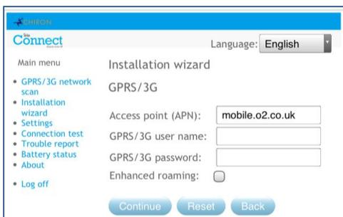
Tous les réseaux GPRS / 3G nécessitent un paramétrage du Nom du point d'accès (APN). Certains nécessitent également un Nom d'utilisateur (USR) et un Mot de passe (PWD).
