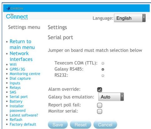
Aquí puede configurar el puerto de serie para el modo de conexiones Premier de Texecom, el modo Galaxy RS485 de Honeywell o el modo normal. El modo predeterminado es el de emulación de Texecom. Para obtener más información sobre la conexión y configuración, consulte el manual de instalación del panel disponible en [http://www.chironsc.com/downloads\\_security.html](http://www.chironsc.com/downloads_security.html).
