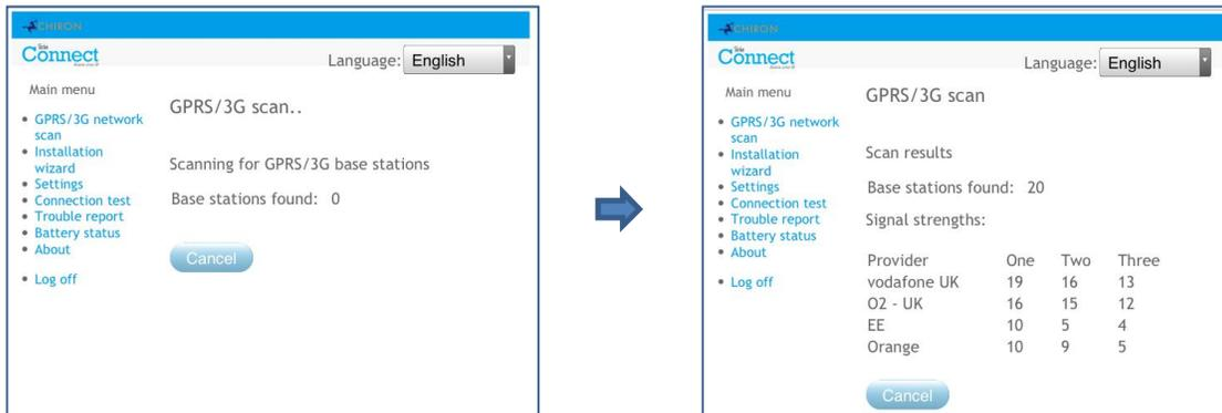
Para establecer una conexión GPRS/3G fiable, se recomienda que haya como mínimo 2 estaciones base con una intensidad de señal (CSQ) de 10 o más para la red (tarjeta SIM) que vaya a utilizarse.
