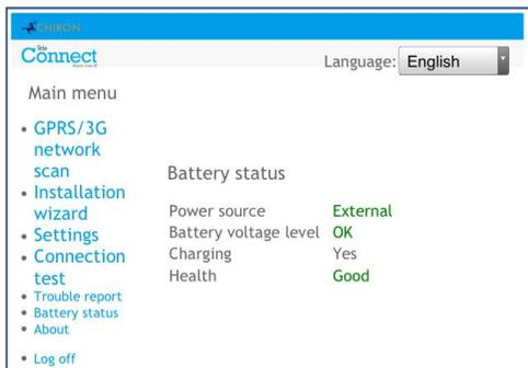
El marcador IRIS Connect permite que los instaladores comprueben el estado de las pilas en cada momento, e indica cualquier problema que pueda haber con ellas.
