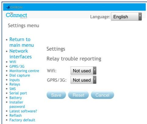
Puede habilitar o deshabilitar el marcador IRIS Connect cambiando el estado de los relés para indicar fallos en las vías de comunicación. El objetivo es notificar los fallos a las entradas del panel para que la ubicación disponga de una indicación local de los fallos de comunicaciones (a efectos de las normas EN).
